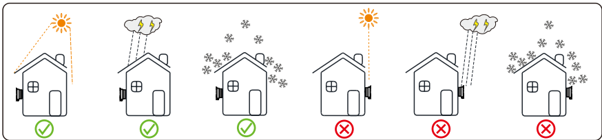
图 5.3 光储一体机安装环境示意
